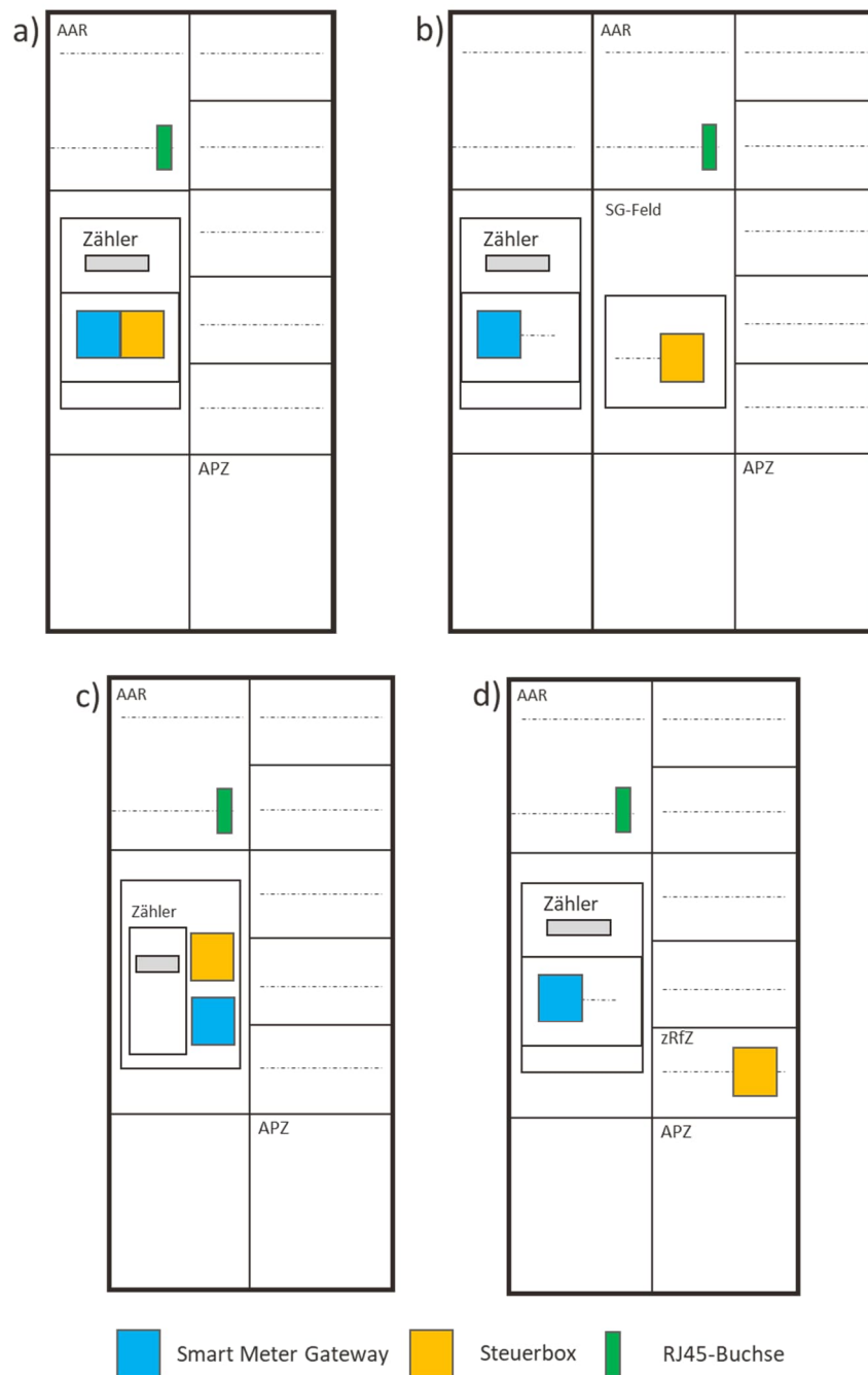
Abbildung 3 - Digitale Steuerung über Dreipunkt-Zählerplatz –
